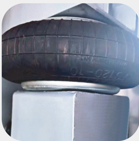
Amortiguador superior por medio de bolsas de aire.
