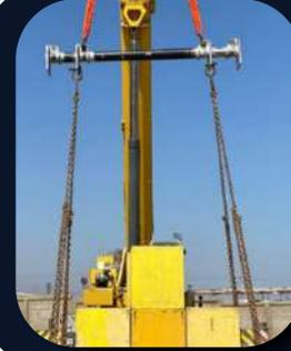
PRUEBA DE CARGA, aplicamos unos nuestros dispositivos de izaje una prueba de carga real con el peso indicado.
