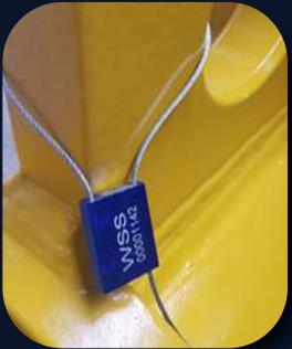
TAG ID, cada prueba de carga realizada va asociada a un componente que puede ser relacionada con el N° de Tag y el certificado de carga.
