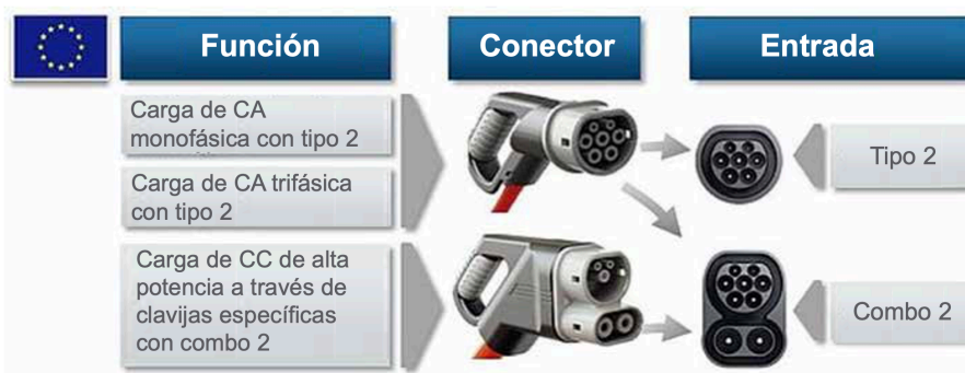
Figura: requisitos de los conectores en la UE (CharIN) [46]
