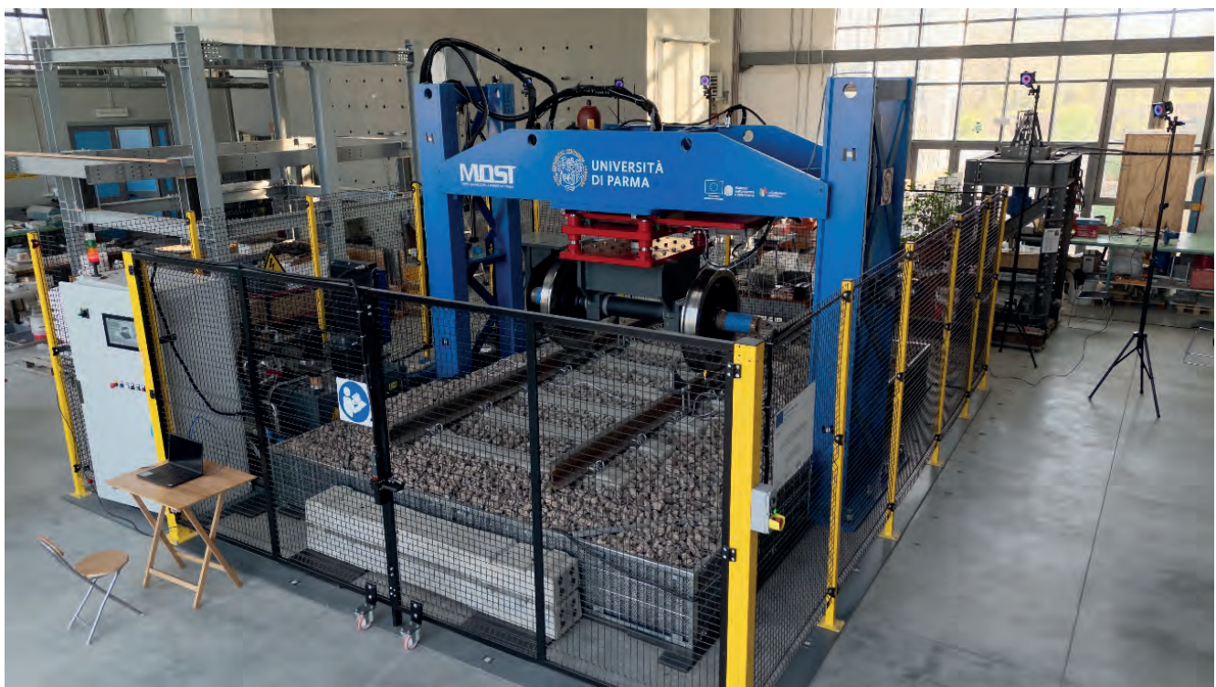
Figura 5 – Vista d'insieme, comprensiva dei sistemi di monitoraggio bordo binario. Figure 5 – Overview, including wayside monitoring systems.
