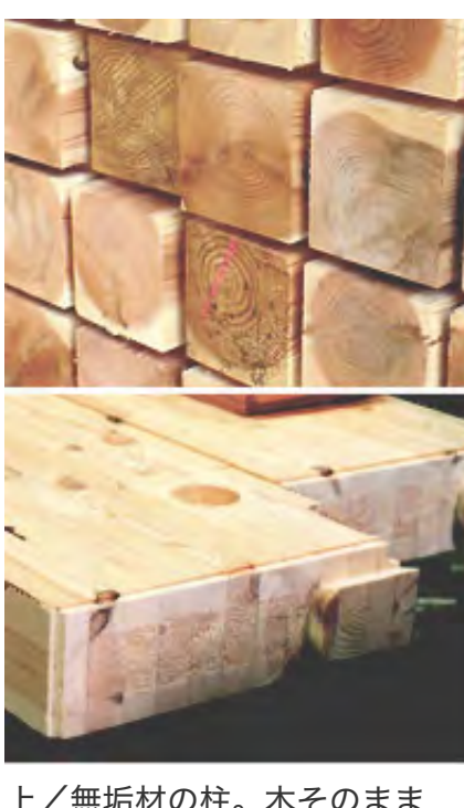
上/無垢材の柱。木そのままの性質をもっている。下/集成材にプレカット加工を施した柱。木を原料とした工業製品である。
