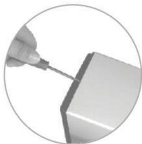
Para abrir a carenagem utilize uma chave de fenda fina, fazendo uma alavanca de dentro para fora, conforme imagem.
