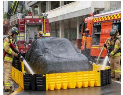
소방관 현장 도착 후 차량을 견인하여 지상으로 이동. 침수조 사용으로 완전 진압.
