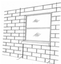
Joonis 13. Deformatsioonivuuk akna all ja silluse kohal
