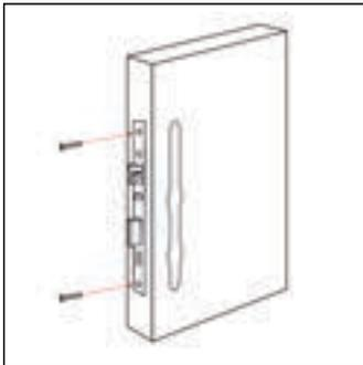
Passo 2 - Instale a parte onde fica o parafuso deslizante
