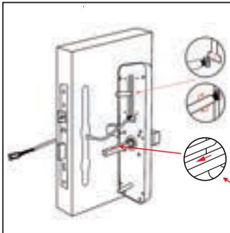
1. A caixa do parafuso é ajustável de 56mm para 123mm.
