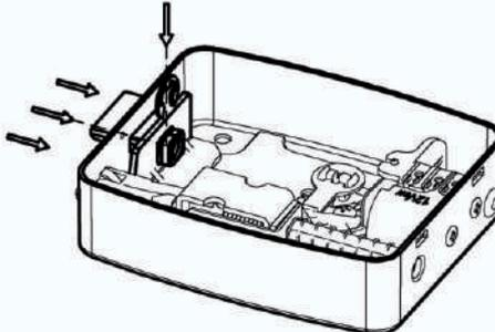
⑥ Pressione com a ponta do alicate, a lingueta e o anel elástico até encaixar totalmente
