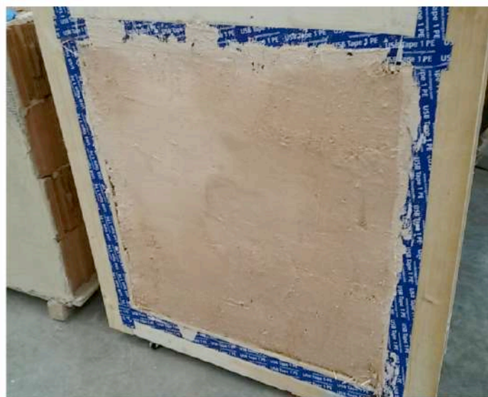
Fig. 1 Immagine del provino prima dell'introduzione nella camera per l'esecuzione delle misure
