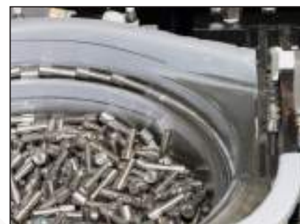
Sopra: Un dettaglio dell'alimentatore automatico brevettato
