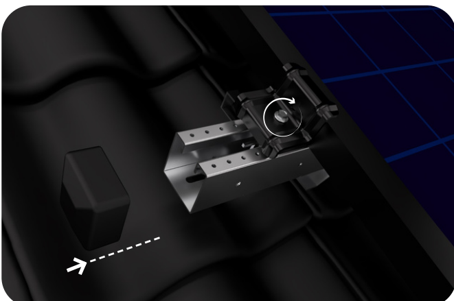
11. Skruva bulten i ändklämmen med 10Nm och sätt på platslock.
