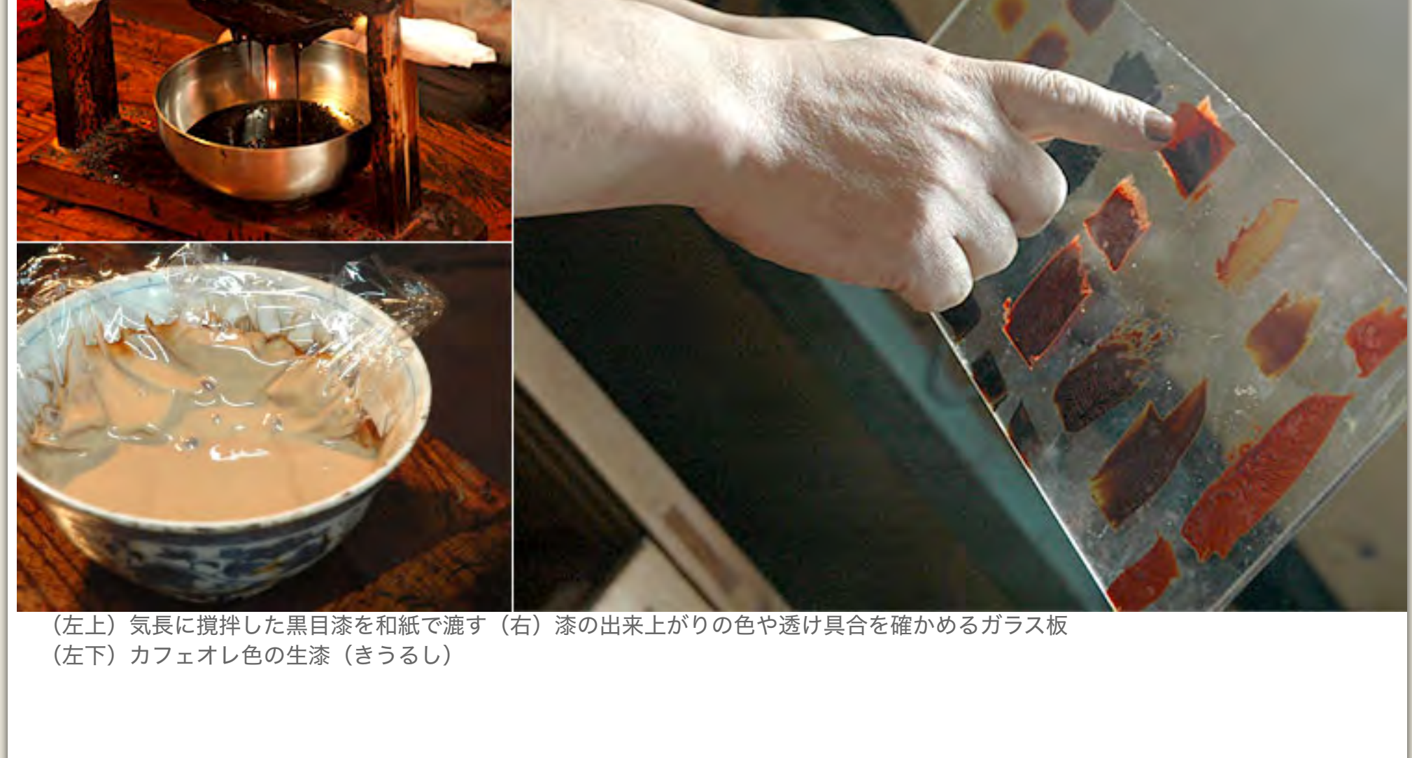
(左上) 気長に摺押した黒目漆を和紙で漉す (右) 漆の出来上がり色や選け具合を確かめるガラス板 (左下) カフェオレ色の生漆（きうるし）
