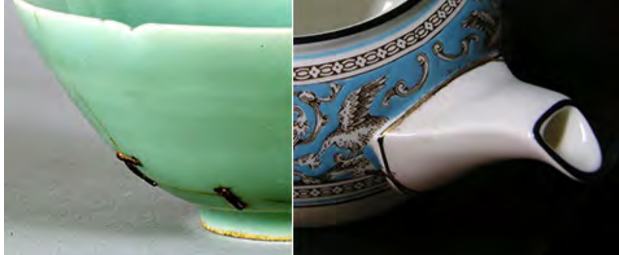
(左) 鉄の鏝(かすがい)で補修した茶碗(東京国立博物館蔵) (右) すっぽりと取れてしまった注ぎ口を「金継ぎ」で補修したウェッジウッドのティーポット
