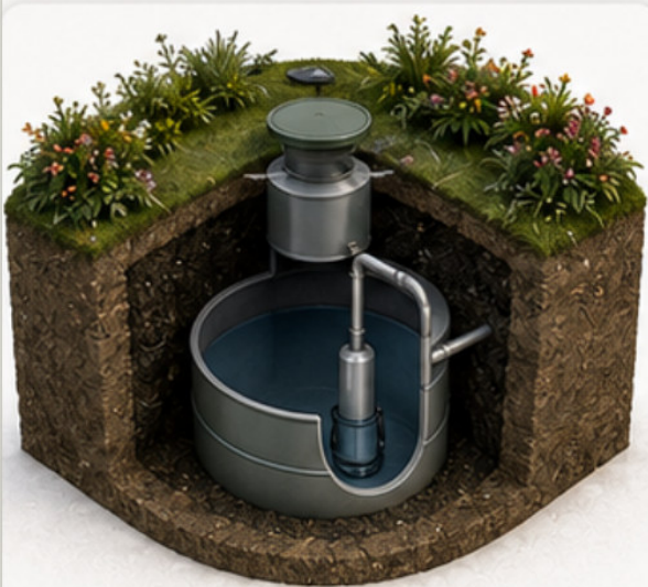
5 Zisterne unterirdisch mit Taucherpumpe
