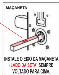
Passo 4 Instale a parte traseira da fechadura
