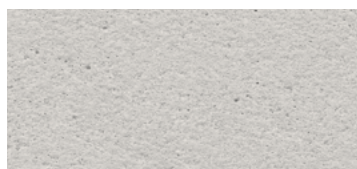
ferro sandgestrahlt mit hohem Druck, Oberfläche ist rau
