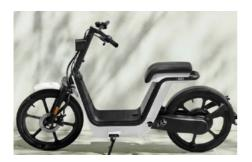
MUJI DESIGNED HONDA'S ELECTRIC BIKE MS01 WITH 400W MOTOR AND 48V LITHIUM BATTERY
