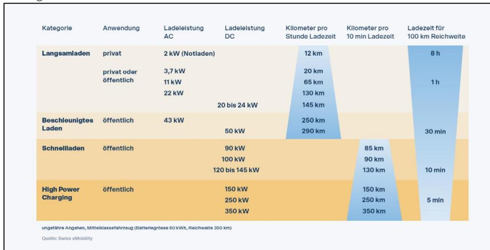
Abbildung 2: Durchschnittliche Ladedauer im Vergleich, Swiss eMobility Glossar, Kap. 3 Schnellladen
