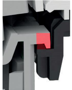
— **Sistema de montaje a presión de 3 puntos**
