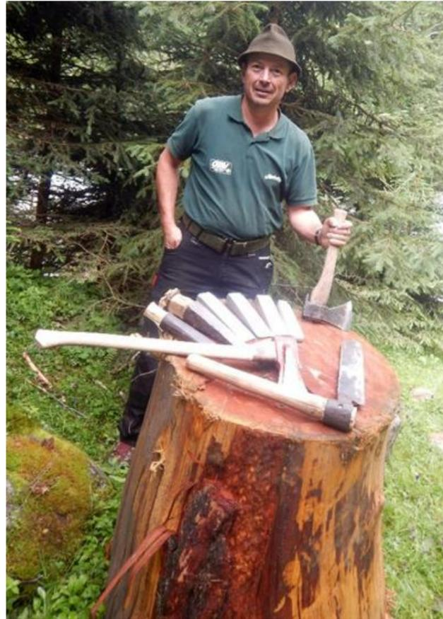
1. Schindelstock mit Spaltkeile, Putzhacken & Schindeleisen
