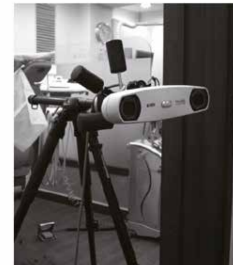
Fig 2. Rastreador óptico (Sistema de Polaris Vicra, Northern Digital, Waterloo, Canadá).
