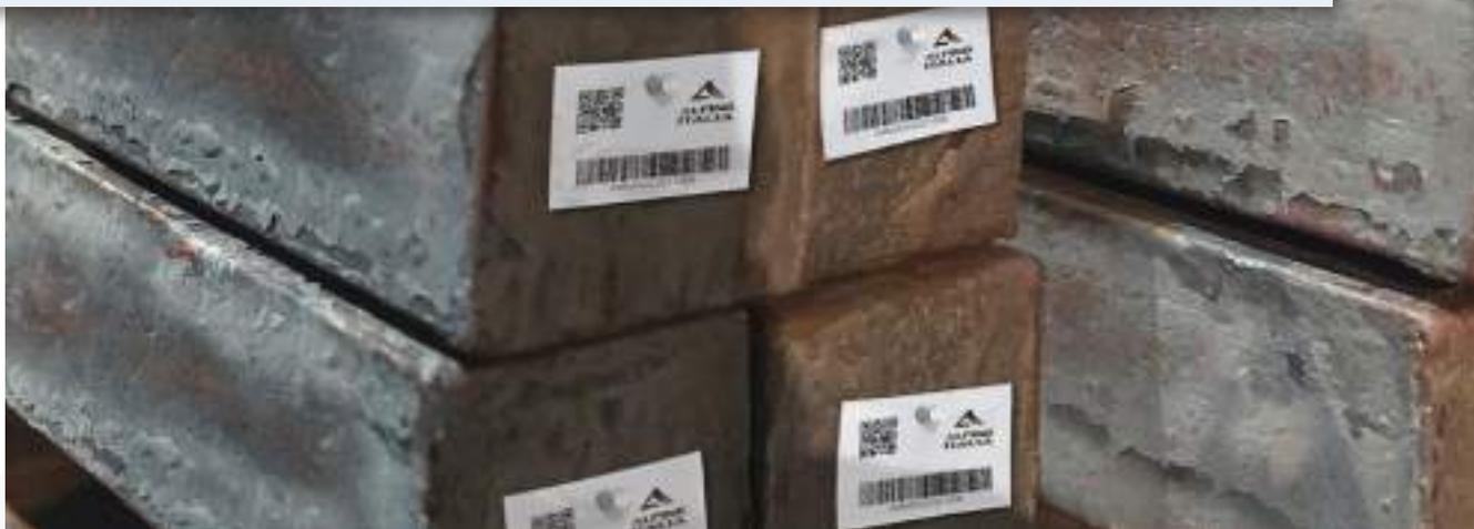
Sopra: Cartellini applicati utilizzando lo speciale perno di saldatura
