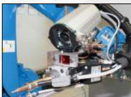
Se il braccio robotico è stato dotato del componente opzionale di visione artificiale, basato su *Smart Camera*, il sistema può verificare ulteriormente se il processo di cartellinatura ha avuto esito positivo e, qualora venga rilevato un problema (ad esempio, informazioni errate o mancanti sul cartellino), esegue le misure previste per darne soluzione.
