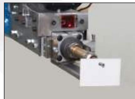
Sopra: un dettaglio della pistola di saldatura e del sistema di visione laser
