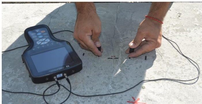
Slika 8. Merenje uređajem Acsys Monolith – longitudinalni UZ senzori 100KHz
