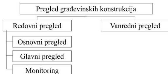
Slika 1. Šematski prikaz sistematizacije pregleda građevinskih konstrukcija
