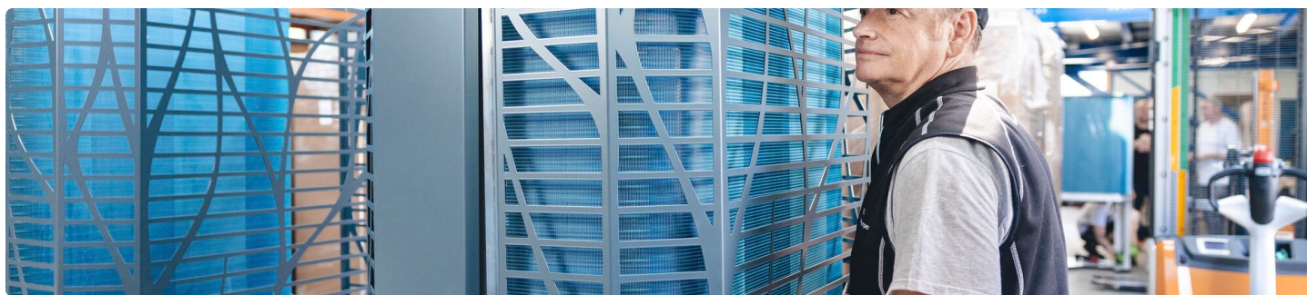
Assemblage van de EUREKA buitenunit in de Lambda-fabriek in Kirchbichl, Oostenrijk
