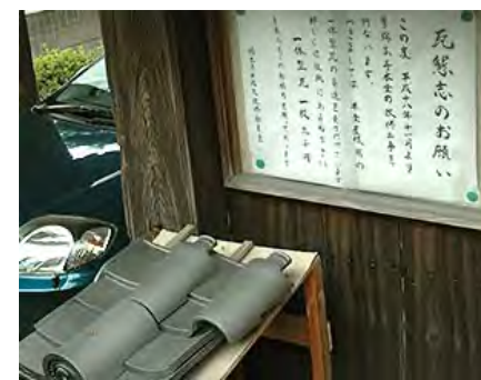
平瓦と丸瓦がひとつになっている一体瓦。瓦懸志の願いが寺の門の前に貼り出されている。
