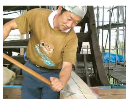
楯がんなを美演してみせしてくれた。くるくると薄いけずり屑が出る。
