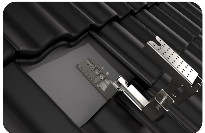
4. Fäst i råspont med 6st 6x30mm träskruv.
