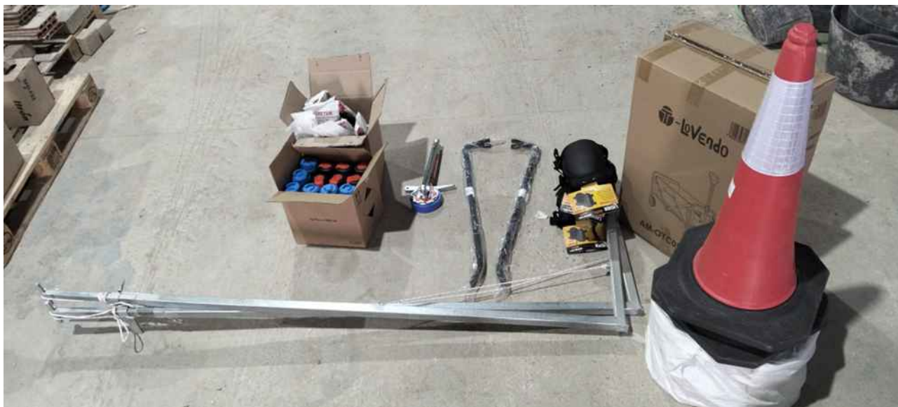
Ilustración 50. Piezas y Herramientas para medición de redes de saneamiento.
