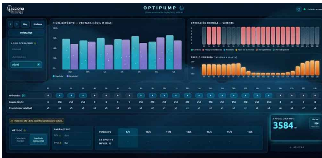
Front-end del modo de funcionamiento por nivel
