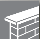
Mauerabschluss mit Abdeckplatten
