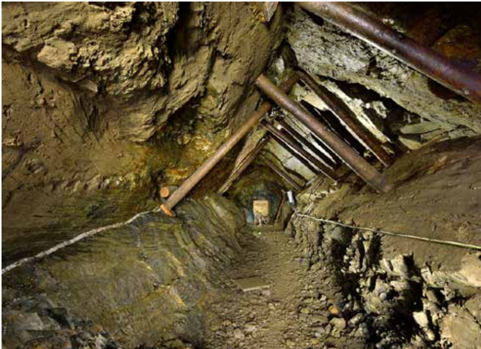
Štola s důlním vozíkem v pozadí, po levé straně zřetelná křemenná žíla
