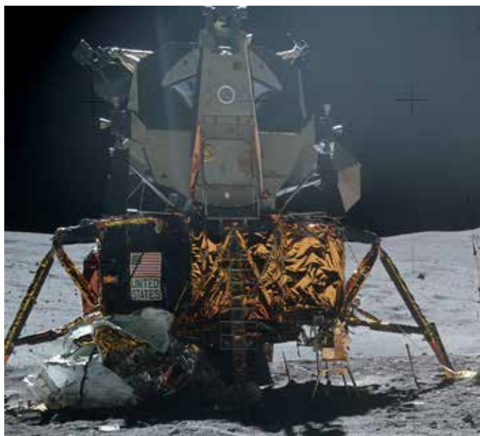
Přistávací modul (LEM) kosmické lodí Apollo na povrchu Měsíce. Celá spodní část je zabalena do vrstvené izolace se zlatou fólií na povrchu.
