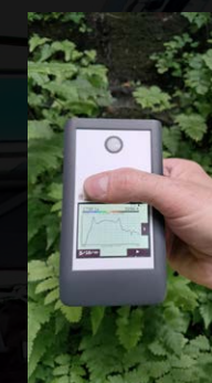
Ci-contre tests d'intensité et installation d'éclairage pour le mur végétal de la Cité de l'espace.
